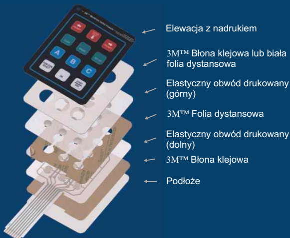
Rys. Typowa konstrukcja klawiatury membranowej
