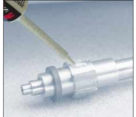
Klejenie magnesów do stalowych wirników.
