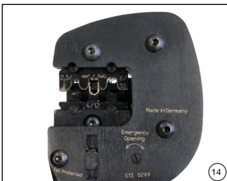
(rys. 14) Lekko docisnąć szczypce, tak aby końcówki zaciskowe znalazły się wewnątrz wnęki szczęk zaciskowych.
