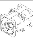
Fig. A: Ribbed fan Fig. B: Counter rotating fan
